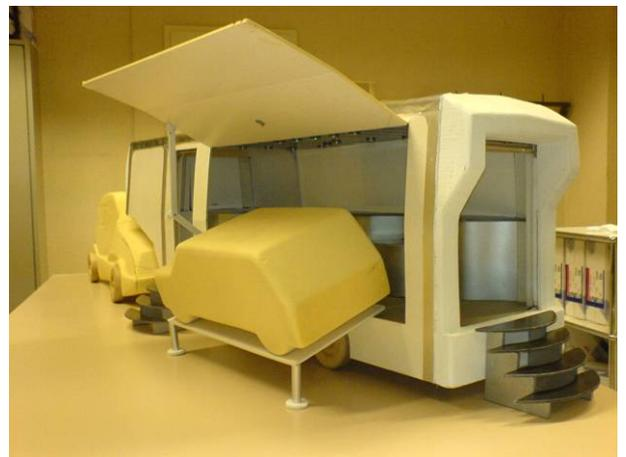
Der Bau des Anhängers wurde mit Hilfe des Systems Co-Bolt aufgebaut und mit geklebten Blechen verschalt.
