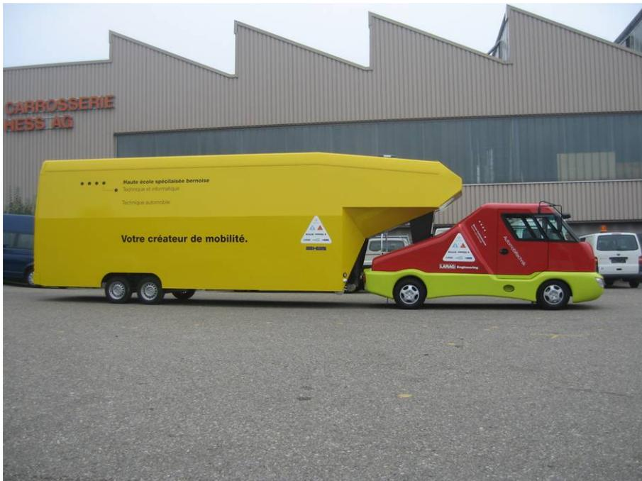
Das Fahrzeug dient verschiedenen Zwecken. Einmal soll es als Bauweisen Labor dienen um den Fahrzeugbaustudenten aufzuzeigen wie ein solches Fahrzeug aufgebaut werden kann. Ferner werden an diesem Fahrzeug Strukturberechnungen mit der Methode der finiten Elemente FEM durchgeführt und mittels Dehnungsmessungen dann ein Vergleich mit der Wirklichkeit aufgezeigt. Im weiteren werden mit dem Fahrzeug Fahr- und Bremsversuche durchgeführt und Messungen erstellt.
